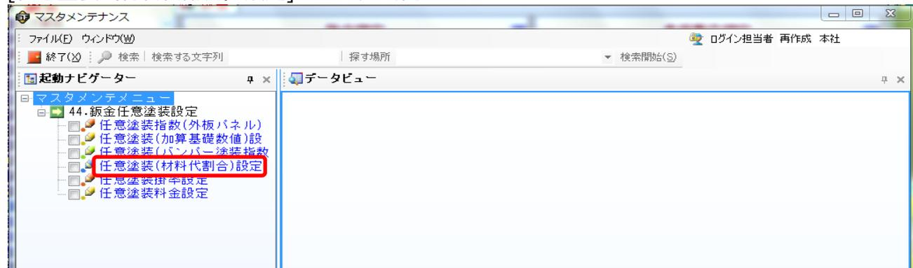
④塗料、塗膜の種類毎に高性能塗装の一覧が表示されるので、設定行いたい「塗料種類」を選択します。
